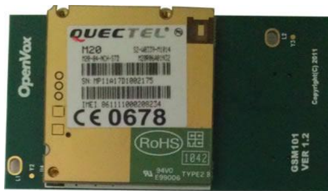
图5 GSM模块（M20）
