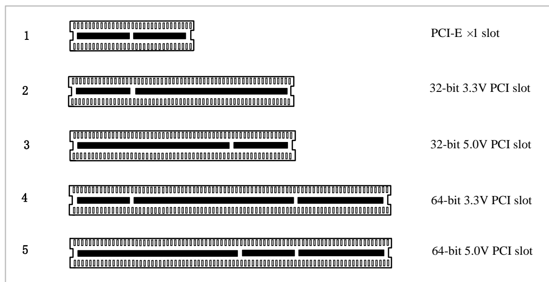
图2 PCI及PCI-E插槽
